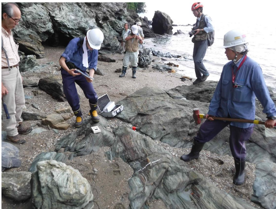
応用地質株式会社のハンディサイズを用いた御荷鉾帯苦鉄質片岩のP波速度の測定
